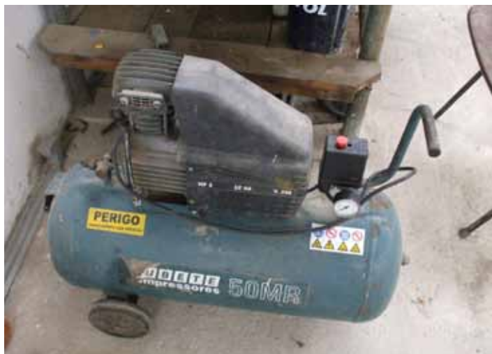
Compressor sem válvula de segurança e pressostato avariado.
