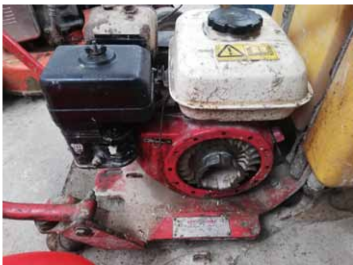
Placa compactadora avariada e sem protecção de elemento rotativo.
