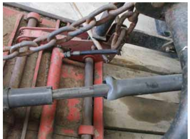
Trator com o tubo do hidráulico rebentado e a proteção do cardan danificada.
